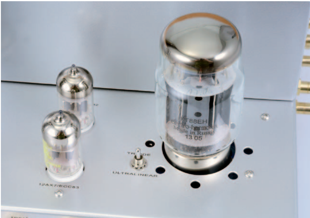
Per Kippschalter von der Pentode im Ultralinearbetrieb zur Pseudo-Triode. Sicherheitshalber sollte man die Umschaltung nur am ausgeschalteten Verstärker vornehmen. Doch die geringe Leistungsausbeute des Triodenbetriebs bleibt dem Teamwork mit extrem wirkungsgradstarken Lautsprechern vorbehalten.
